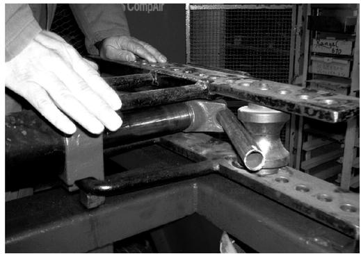
**7-** Vérifier l'angle par visée à l'aide d'une équerre ou d'une fausse équerre.
