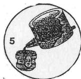
On obtient de l'acier liquide, qui va être acheminé vers l'installation d'affinage et de mise à la nuance.
