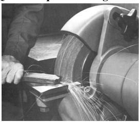
Le meulage fait partie de la catégorie de « l'usinage par abrasion ». Cette usinage consiste à enlever de la matière par des grains d'abrasifs liés à une surface souple (bande de ponceuse) à des volumes solides (meules) ou libres les uns par rapport aux autres.
